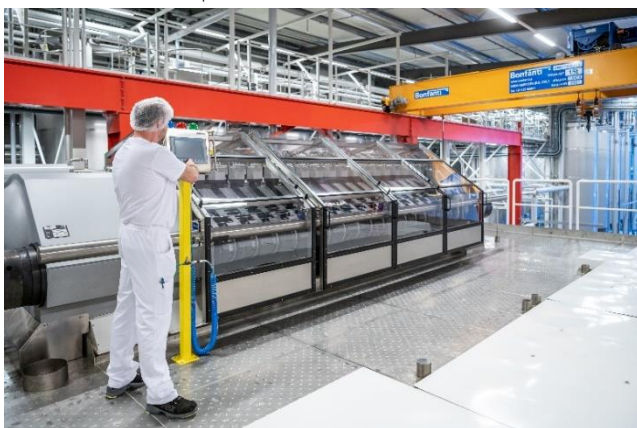
Dans la presse à beurre de cacao, la masse de cacao bio fraîchement traitée est pressée délicatement et le beurre liquide est séparé du tourteau qui servira à fabriquer la poudre de cacao. (Photo: © PRONATEC AG)
